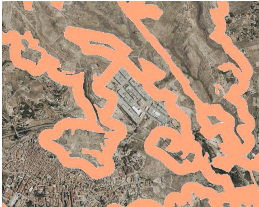
Figura 51. Afección por riesgo de incendio forestal (en naranja) del polígono, al estar a <100 m de monte
